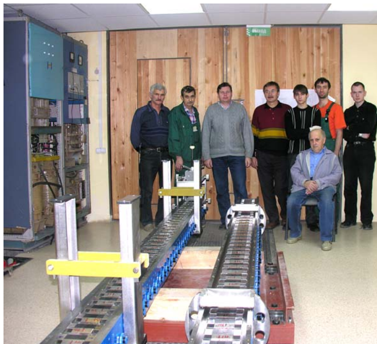
Рис. 40. Первые изготовленные вигглеры-затухатели на постоянных магнитах для Petra-III на стенде магнитных измерений.
