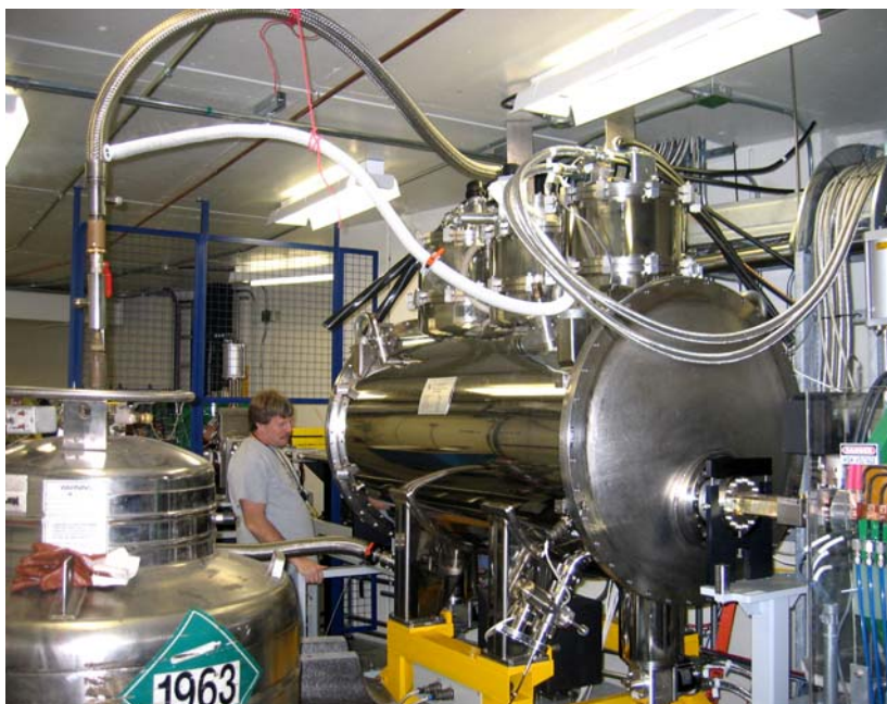
Рис. 37. 27-полюсный сверхпроводящий вигглер для биомедицинских исследований с полем 4.3 Тл и периодом 48 мм на накопителе Canadian Light Source (CLS, Канада).
