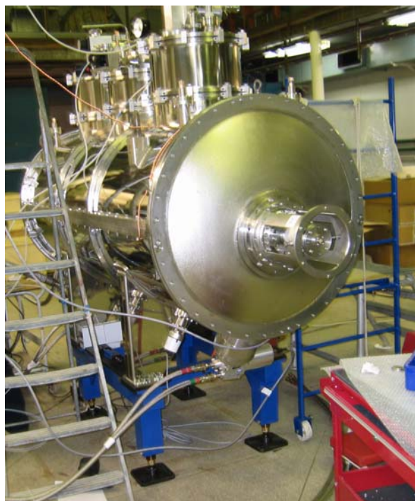
Рис. 35. 21-полюсный сверхпроводящий вигглер с полем 7.7 Т для источника СИ «Сибирь-2» в процессе сборки.
